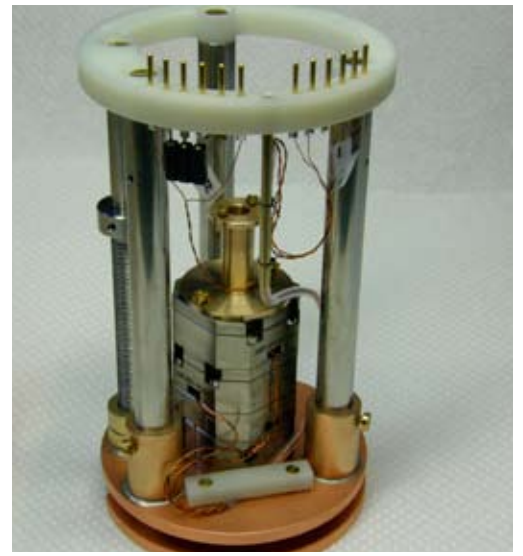
Probenkopf-Oberteil mit Piezzo-Slider.
